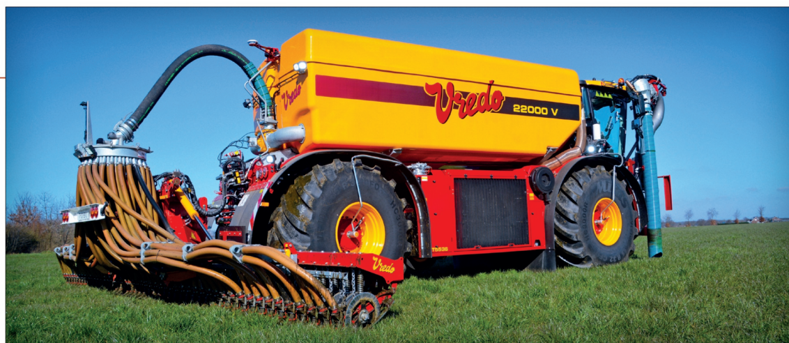
Prostřednictvím krátkého tříbodového závěsu zvládnou samojízdné stroje Vredo i těžké aplikátory o velkém záběru
