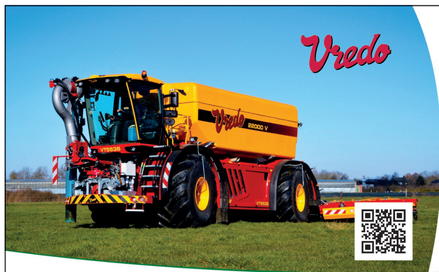
K rovnoměrnému utužení půdy přispívá také krabí chod
