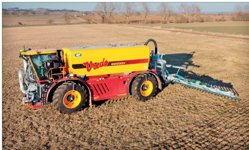
K přesnému zapravení kejdy a digestátu využívají aktivní NIR senzor a section control
