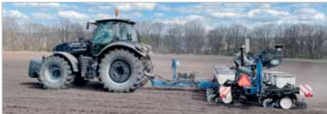
Změna z úzkořádku na klasickou rozteč řádků je u secího stroje Kinze velice rychlá a provádí se na poli. Proto je technologie Kinze jedinečná nejen pro setí pokusů, ale především pro zemědělskou praxi
