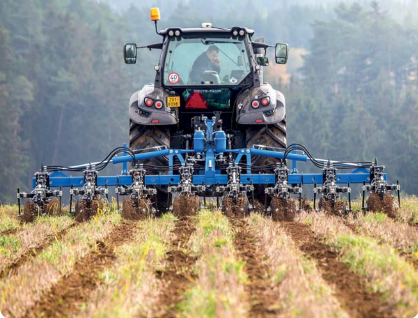
Eco Tiller je stroj na pásové zpracování půdy vyvinutý a vyrobený společností P & L
