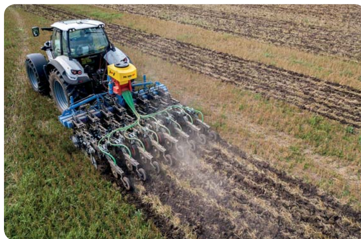
Základem Seed Tilleru je opět Eco Tiller osazený secím strojem APV a doplněný bezorebnými secími botkami
