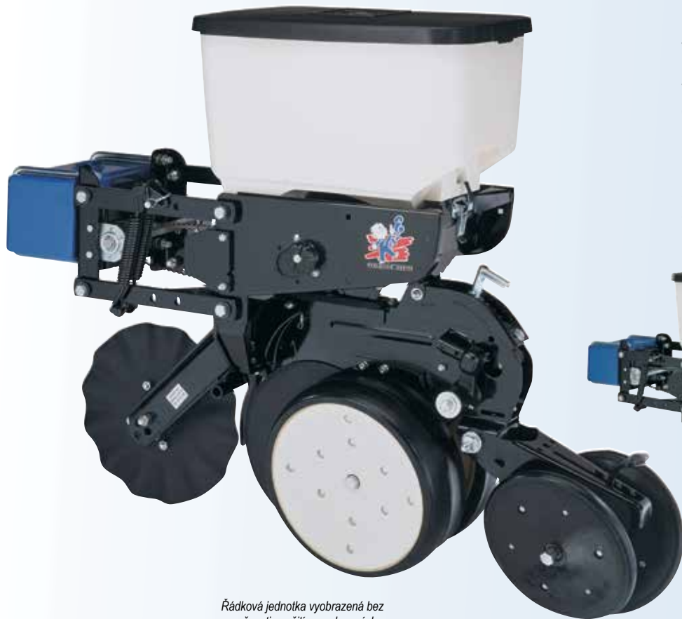
Řádková jednotka vyobrazená s možností použití granulovaných chemických přípravků.
