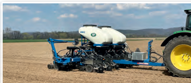
Foto 2 – Setí stroj Kinze 3505 ASD 8R Interplant (MJM Litovel) při setí kukuřice na pozemcích ZD Dolany. Rozteč řádků 37,5 cm, výsevek 110 tis. jedinců/ha Foto Dolany 2023
