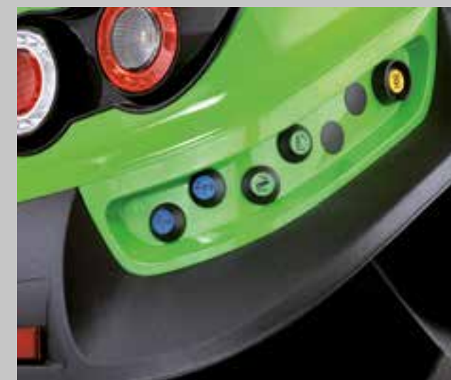
Hydrauliku, EHR i vývodovou hřídel je možné ovládat pomocí externích tlačítek na obou blatnících.
