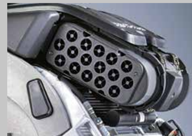
Odlučování hrubých nečistot zajišťují spirálovité cyklónové roury a sací hadičky, které odloučí až 95% všech částic ještě předtím, než se dostanou do filtru.
