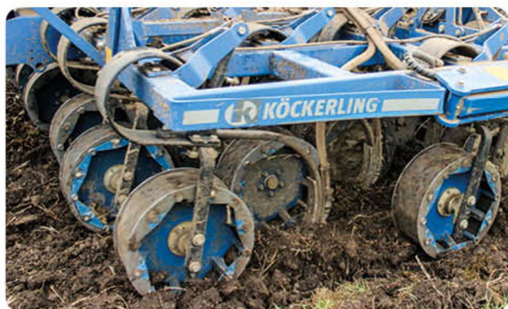
Sečí botky jsou samostatně vedeny klecovým opěrným kolem v nastavené hloubce setí
