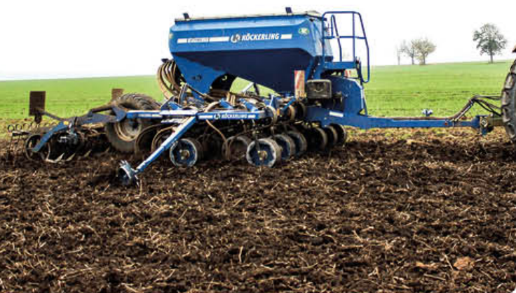
Nasazení ve službě. Výsev pšenice 180 kg/ha na pozemku po sóji, zpracovaném po sklizni pouze dvěma přejezdy talířovým podmičákem
