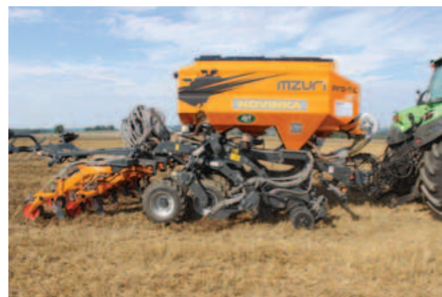
• U modulárního secího stroje Mzuri Pro-Til 4Tx lze nastavit dávkování až čtyř druhů hnojiv a osiv s proměnlivými dávkami podle map precizního zemědělství
