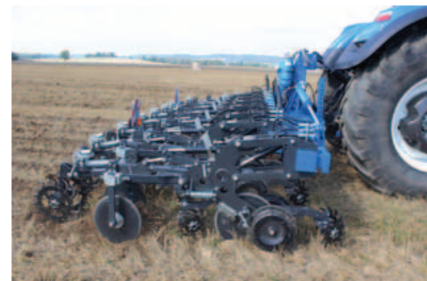
• Prodloužená pracovní jednotka stroje Eco Tiller je konstruovaná do všech půdních podmínek s velkým množstvím rostlinných zbytků
