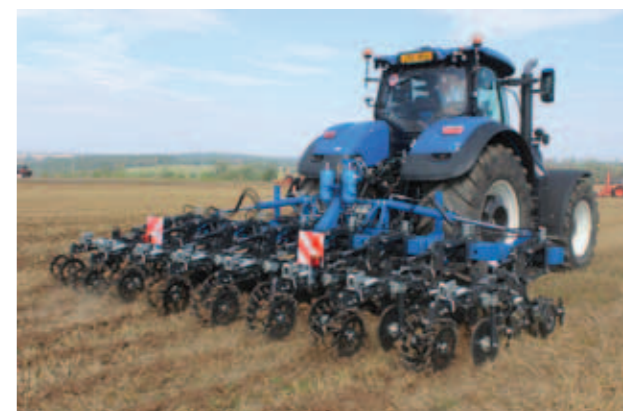
• Eco Tiller vytváří během intenzivního zpracování půdy velké hrůbky, které přes zimu slehnou, takže na jaře se už seje do rovných pásů nezbytných pro přesné setí
