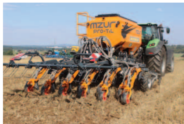
• Secí stroje Mzuri s proměnlivými dávkami osiv, hnojiv či pesticidů zapadají do systému precizního zemědělství
