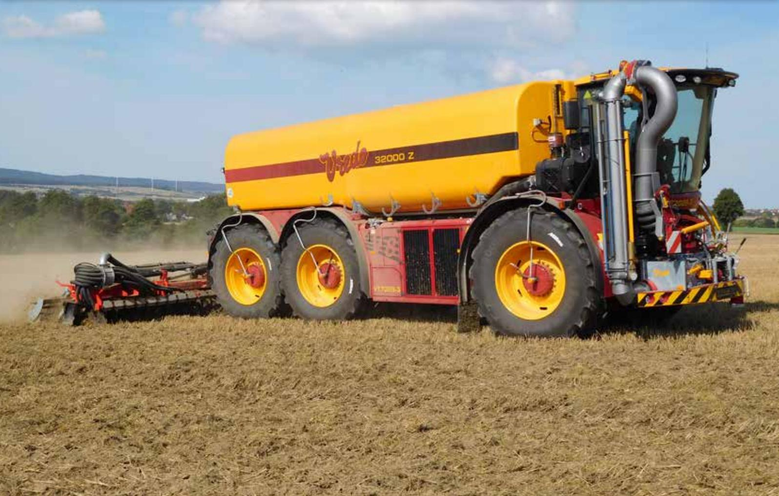
Die Nachfrage nach höherer Fahrzeugleistung zur Injektion von Gülle und trockenen Materialien in der Landwirtschaft hat zu dem neuen Vredo VT7028 System-Trac in Zwei- oder Drei- Achs Ausführung geführt. Dieser neue Trac hat in der Mitte des Fahrzeugs einen Deutz 16 Liter V8 motor mit 687 PS und dem neuen Vredo VVT700 Vario-Getriebe montiert.
