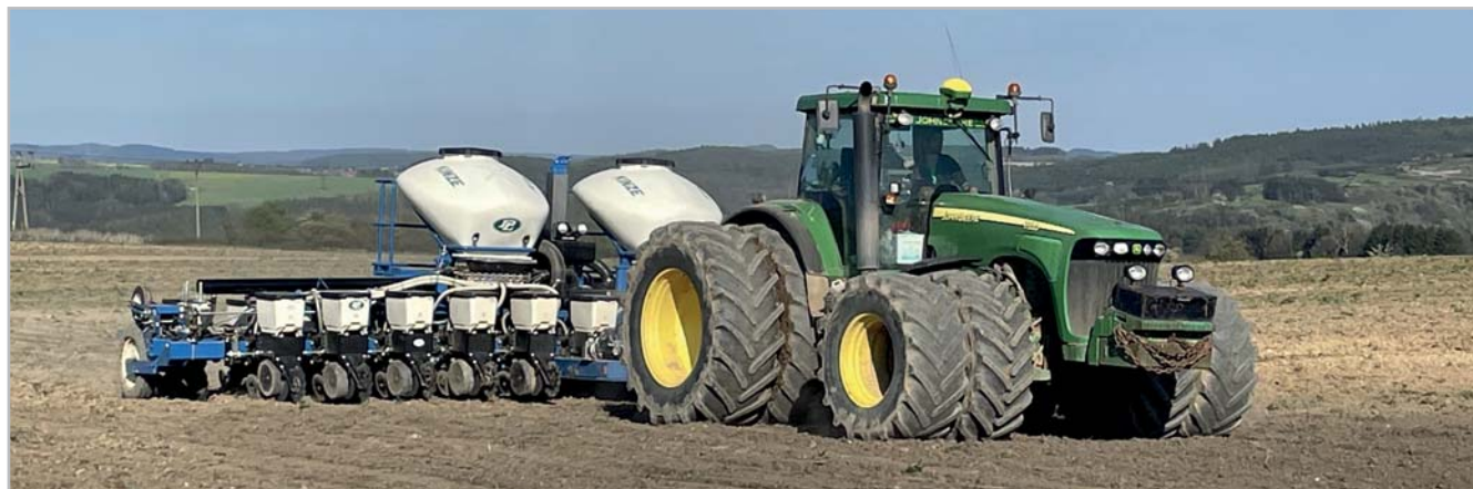
Secí stroj je vybaven dvěma centrálními zásobníky na hnojivo
