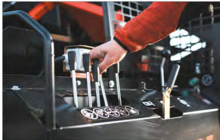
Benefitem je jednoduché a komfortní, plně hydraulické ovládání celého stroje pomocí joysticku a prvků situovaných na ovládacím panelu
