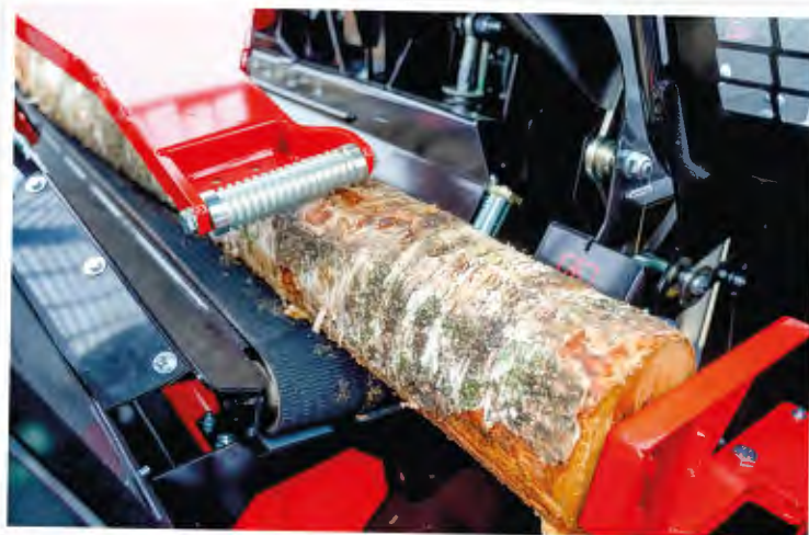
Díky automatickému hydraulickému upínání kulatiny je proces řezání bezpečný a rychlý
