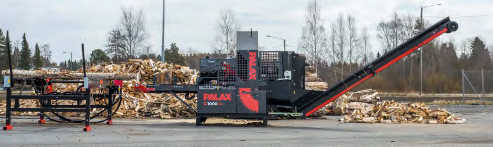
Největším z rodiny Palax C je štípací automat Palax 1000.2. Své označení 1000 dostal v souvislosti s průměrem řezného kotouče, který je 1000 mm
