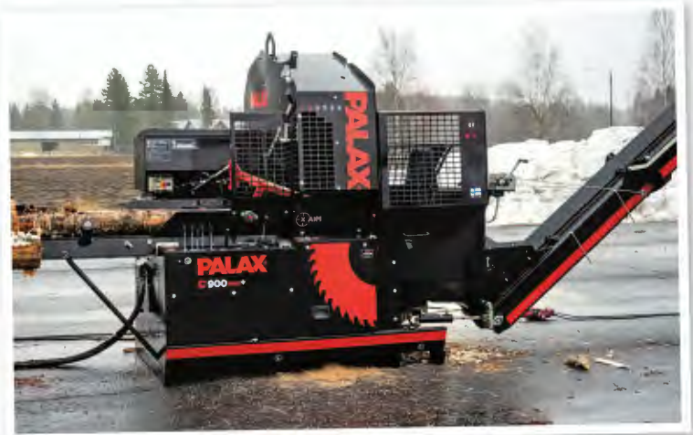
Štípací automat Palax 900.2 disponuje řezací kotoučem o průměru 900 mm a dokáže nařezat kulatiny do maximálního průměru 37 cm na polena o délce 25–55 cm
