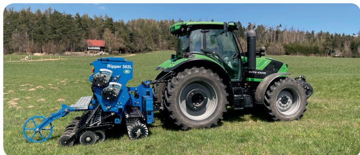
Nový koncept secího stroje Ripper 302 s roztečí řádků 13,6 cm a dvoukomorovou výsevní skříň
