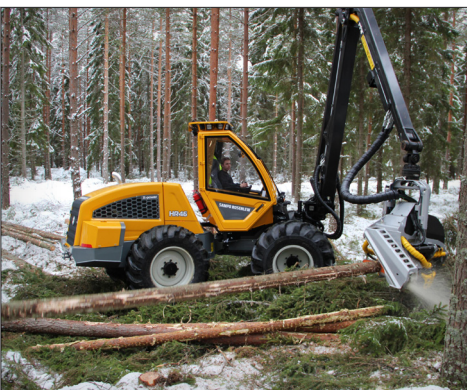
Probírkový harvester Sampo Rosenlew HR46
