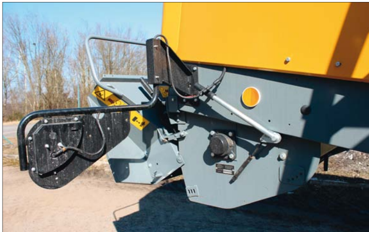
Otočením páky se překlápí usměrňovací clona, která směřuje proud slámy do drtiče, nebo mimo něj
