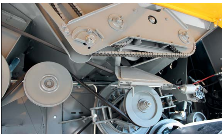
Na pravé straně je umístěn variátor pro regulaci otáček mláticího bubnu, nad ním řetězové pohony šnekových dopravníků v zásobníku
