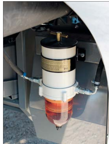
Volitelnou výbavou pro ČR je přidavný palivový filtr s odlučovačem vody
