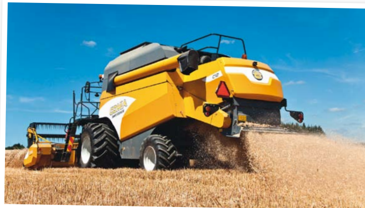
V nabídce sklízecích mlátiček Comia jsou dva typy drtičů. U modelu C12 je použito větší provedení s otáčkami 3900 za minutu
