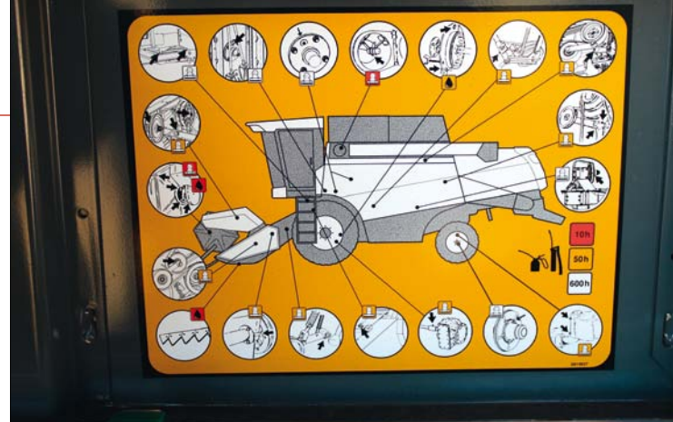
Mazací plán ukazuje, že mazacích míst není mnoho, několik z nich vyžaduje denní údržbu. Firma Sampo nabízí i systém sdruženého mazání, kdy se maže z několika míst centrálně, v praxi jej však zemědělci nepožadují
