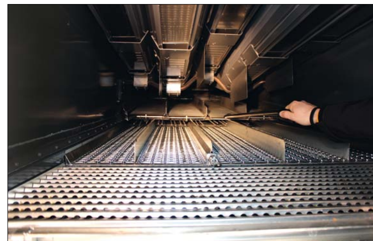
Žaluziová síta jsou u modelu C8 mechanicky stavitelná, pomocí dodávané páky lze vyjmout i segmenty vynášecí desky
