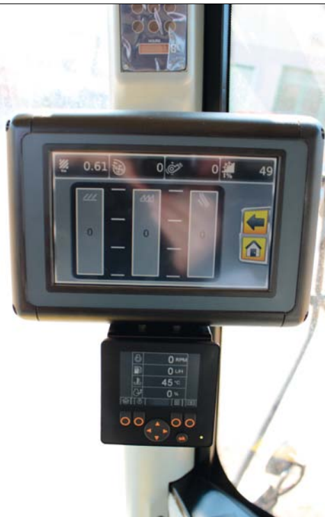
Dotekový monitor pro kontrolu a seřízení sklízecí mlátičky, pod ním ještě přídavný motor ukazující důležité provozní parametry motoru
