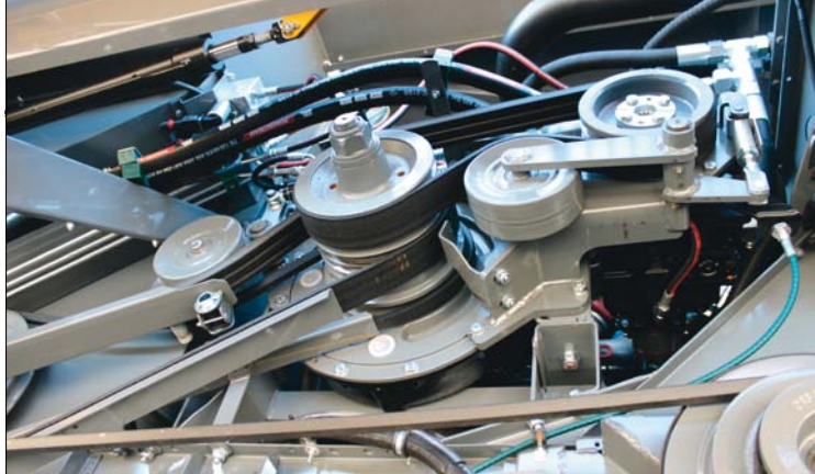
Motor je uložen příčně, pohony a hydrogenerátory jsou umístěny klasicky, na levé straně
