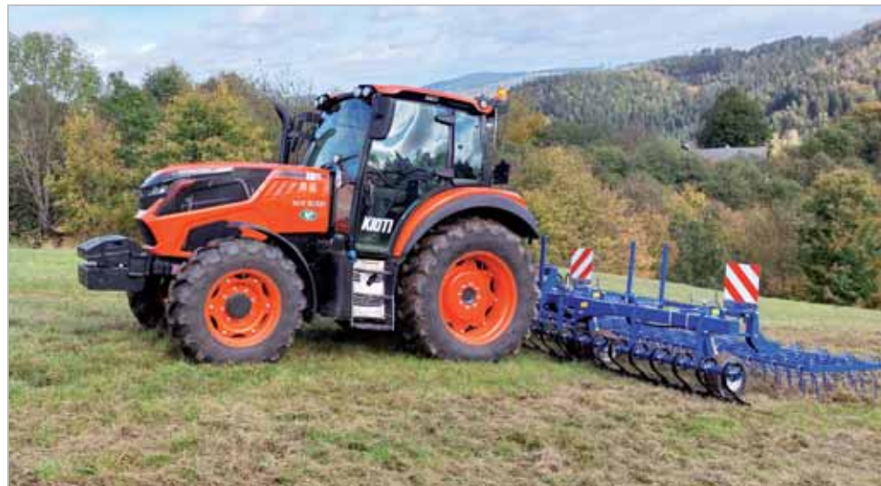
Traktor Kioti HX o výkonu 90 až 140 koní je osazen převodovkou Power shuttle nebo Powershift
