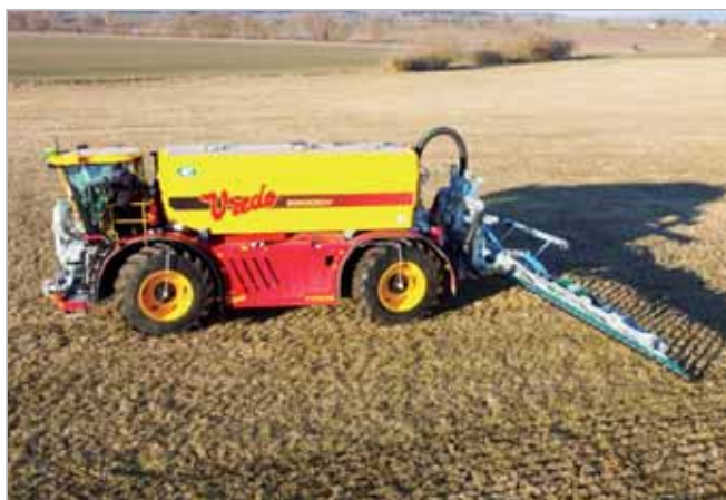
Technicky vyspělé a k půdě ohleduplné aplikátory Vredo jsou určeny k zapravení kejdy a digestátu
