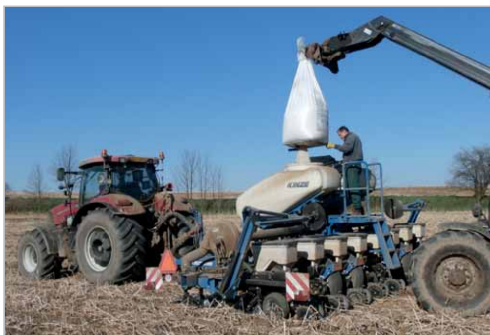
Dva centrální zásobníky podstatně zkracují čas plnění osivem
