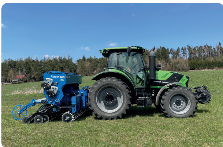
Nový koncept secího stroje Ripper 302 s roztečí řádků 13,6 cm a dvoukomorovou výsevní skříní
