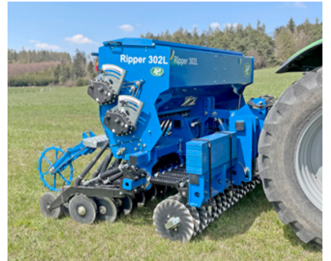
Nový koncept sejacieho stroja Ripper 302 s rozstupom riadkov 13,6 cm a dvojkomorovou výsevnu skriňou.
