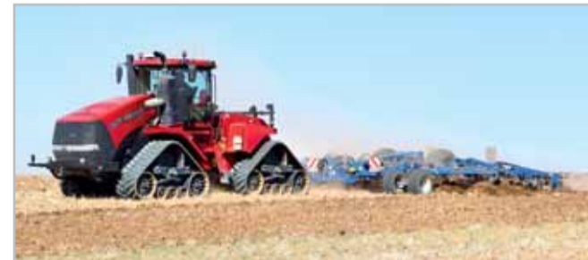
Vector je agregován s traktorem Case IH Quadtrac o výkonu 620 k Foto archiv
