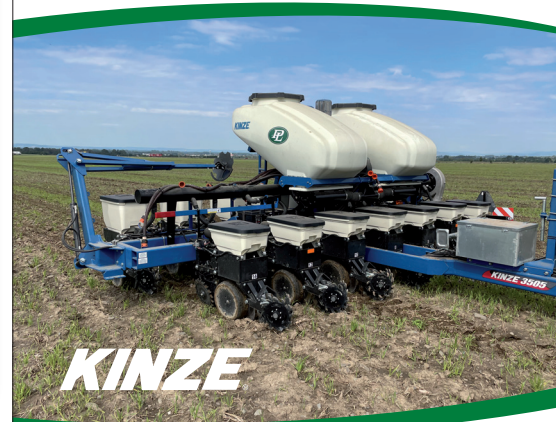
Secí stroj Kinze při setí kukuřice na rozteč řádků 37,5 cm technologií no-till přímo po sklizni GPS Foto archiv firmy
