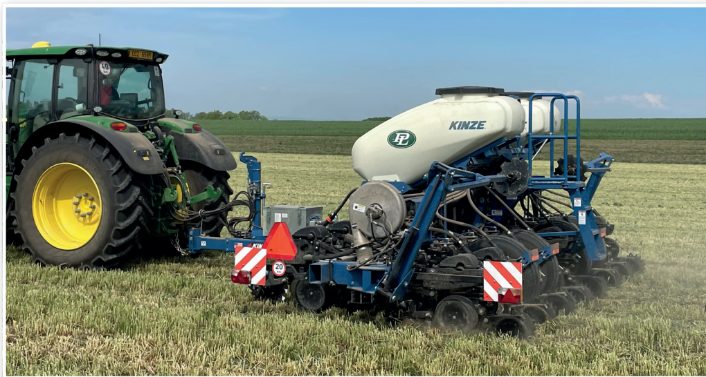
Secí stroj Kinze při setí kukuřice na rozteč řádků 37,5 cm technologií no-till přímo po sklizni GPS Foto archiv firmy
