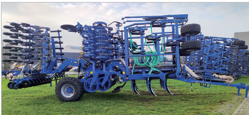
Master je nový stroj společnosti Köckerling pro pásové zpracování půdy metodou strip-till
