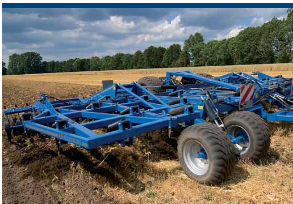
Köckerling Allrounder-flatline je robustní a univerzální předsetový kombinátor, který je určen pro zpracování půdy do hloubky 12 cm Foto archiv
