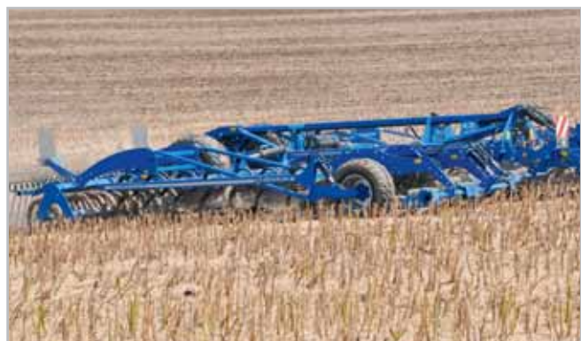
Köckerling Allrounder-flatline je robustní a univerzální předsetový kombinátor, který je určen pro zpracování půdy do hloubky 12 cm Foto archiv
