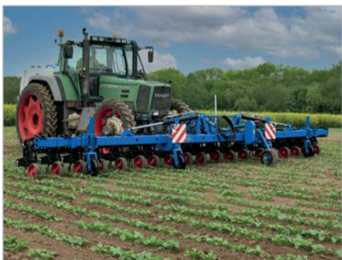
Meziřádkový kypřič Multi Cropper 18 řádků v čelně nesené verzi lze snadno v zemědělském podniku přestavět na zadně nesenou verzi s kamerovým systémem pro navádění do řádků Foto archiv firmy
