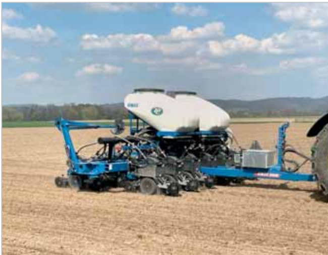
Setí stroj Kinze 3505 ASD 8R Interplant (MJM Litovel) při setí kukuřice na pozemcích ZD Dolany. Rozteč řádků 37,5 cm, výsevek 110 tis. jedinců/ha Foto Dolany 2023
