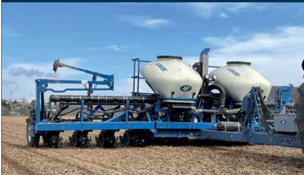
Setí stroj Kinze 3505 ASD 8R Interplant (MJM Litovel) při setí kukuřice na pozemcích ZD Dolany. Rozteč řádků 37,5 cm, výsevek 110 tis. jedinců/ha Foto Dolany 2023
