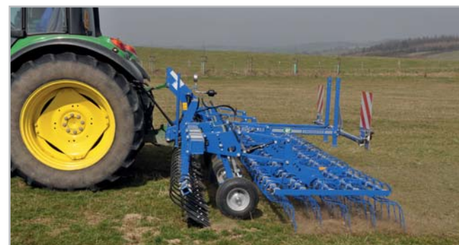
Brány Köckerling Grasmaster jsou určeny jednak k provzdušnění drnu, jednak k účinnému zničení mechů, různých plevelů a k vytažení stařiny. Foto archiv firmy
