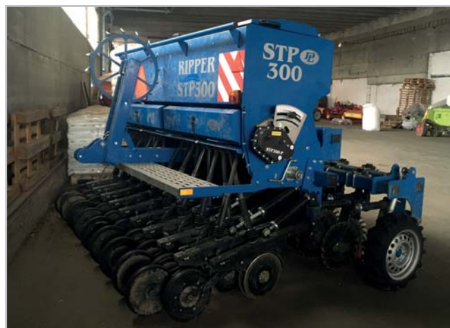
Secí stroj Ripper STP 300 je postaven na masivním rámu, který zaručuje kvalitní práci i v těžkých podmínkách, například na kamenitých nebo těžkých půdách. Foto archiv firmy
