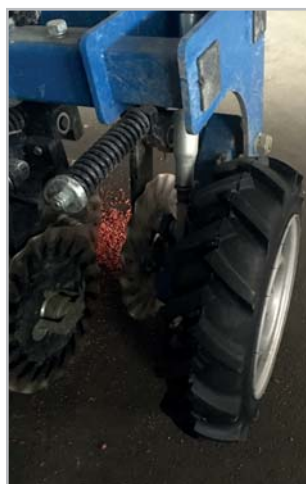
V Agru Liboměřice si nechali stroj vybavit ještě kopírovacími koly, které v případě práce na orné půdě a za vlhkých podmínek pracovní orgány nadlehčují. Foto archiv firmy
