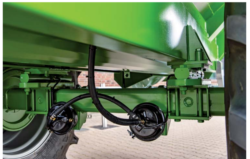
Vázící snímače jsou u GTW 210 integrovány mezi pevnou nápravou a zásobníkem. Navíc je na oji namontováno speciální měřící tažné oko. Dá se tak dosáhnout velmi přesného měření.
