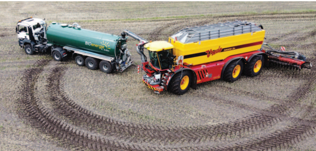
Obr.: Kompaktní konstrukce a řízená náprava OMSI činí z nového modelu Vredo VT7138-3 obratný stroj schopný rychlého otáčení na souvrati pole.
