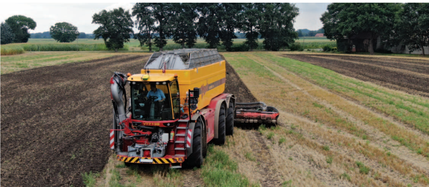
Obr.: Na přání může být stroj vybaven nádrží o objemu 25 000 litrů spolu se systémem FlexTank, jehož prostřednictvím lze objem flexibilně navýšit o dalších 7 000 litrů
