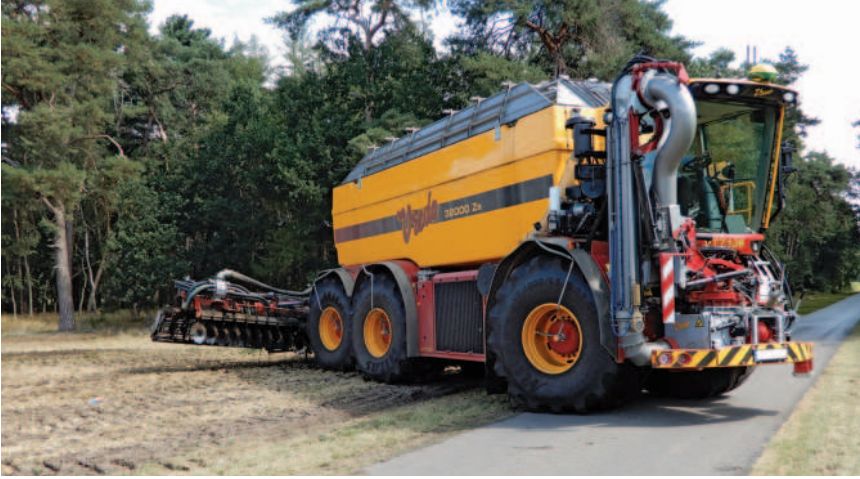
Obr.: Novinkou je větší rozměr nasávacího ramene umístěného před kabinou, jež slouží pro plnění nádrže.
