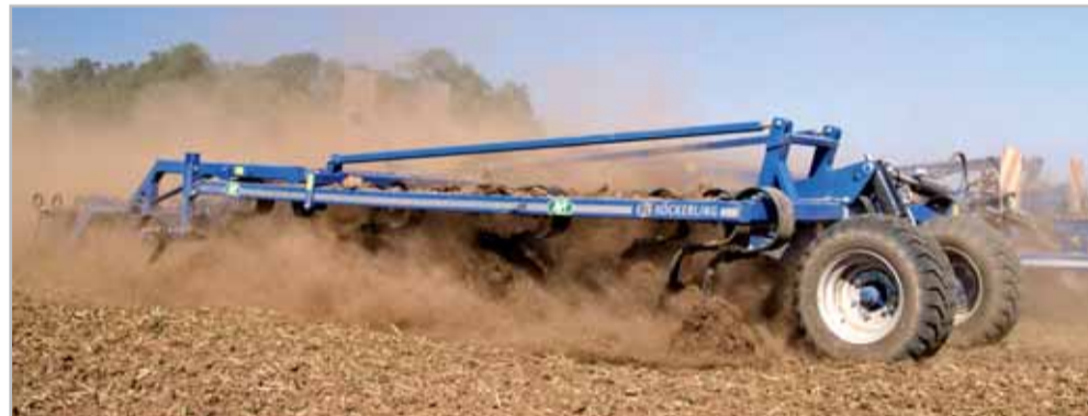
Kypřič Vario půdu nejen zpracovává, ale navíc také významně rovná povrch pole
