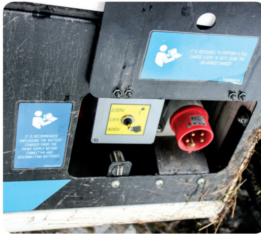
Na místě motoru jsou akumulátory, nad pravým zadním blatníkem skříňka s rychlonabíječkou
