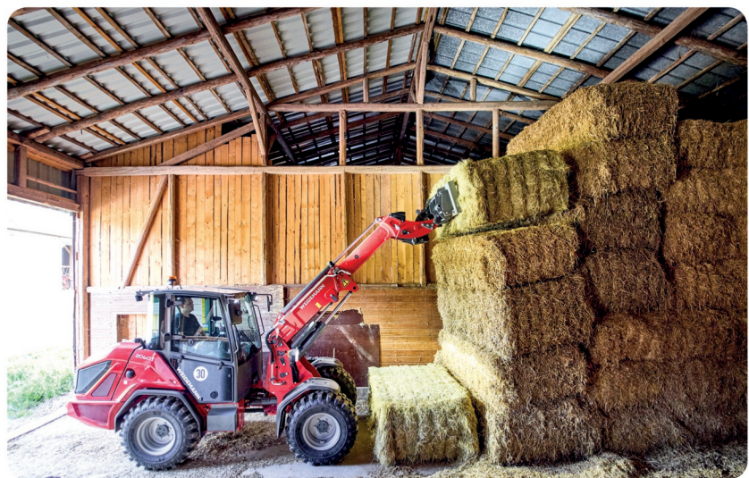
Teleskopická verze nakladačů Weidemann 60 má výšku zdvihu od 4,30 do 5,04 m
