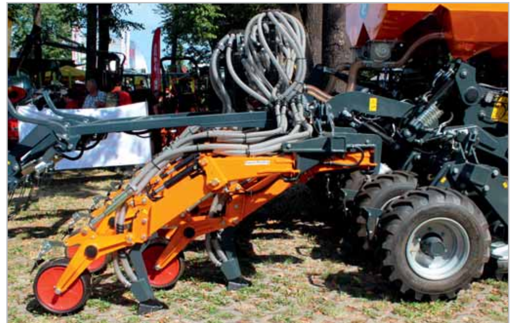
Pracovní nástroje a secí botky jsou hydraulicky jištěné
