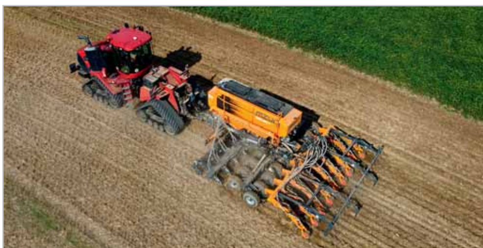
Secí stroje Mzuri s proměnlivými dávkami osiv, hnojiv či pesticidů zapadají do systému precizního zemědělství
