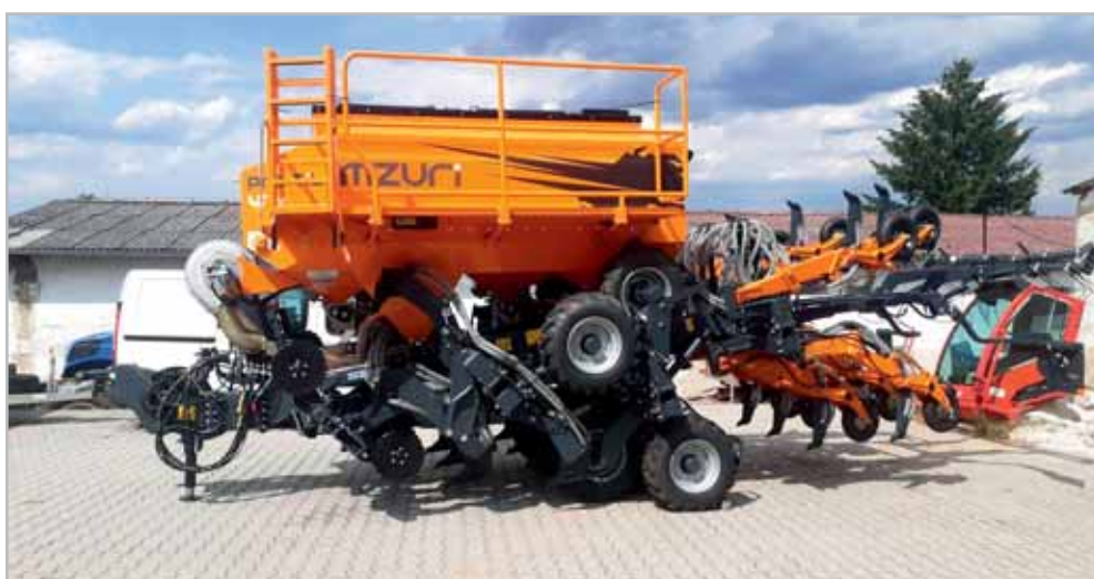
U modulárního secího stroje Mzuri Pro-Til 4Tx lze nastavit dávkování až čtyř druhů hnojiv a osiv s proměnlivými dávkami podle map precizního zemědělství
