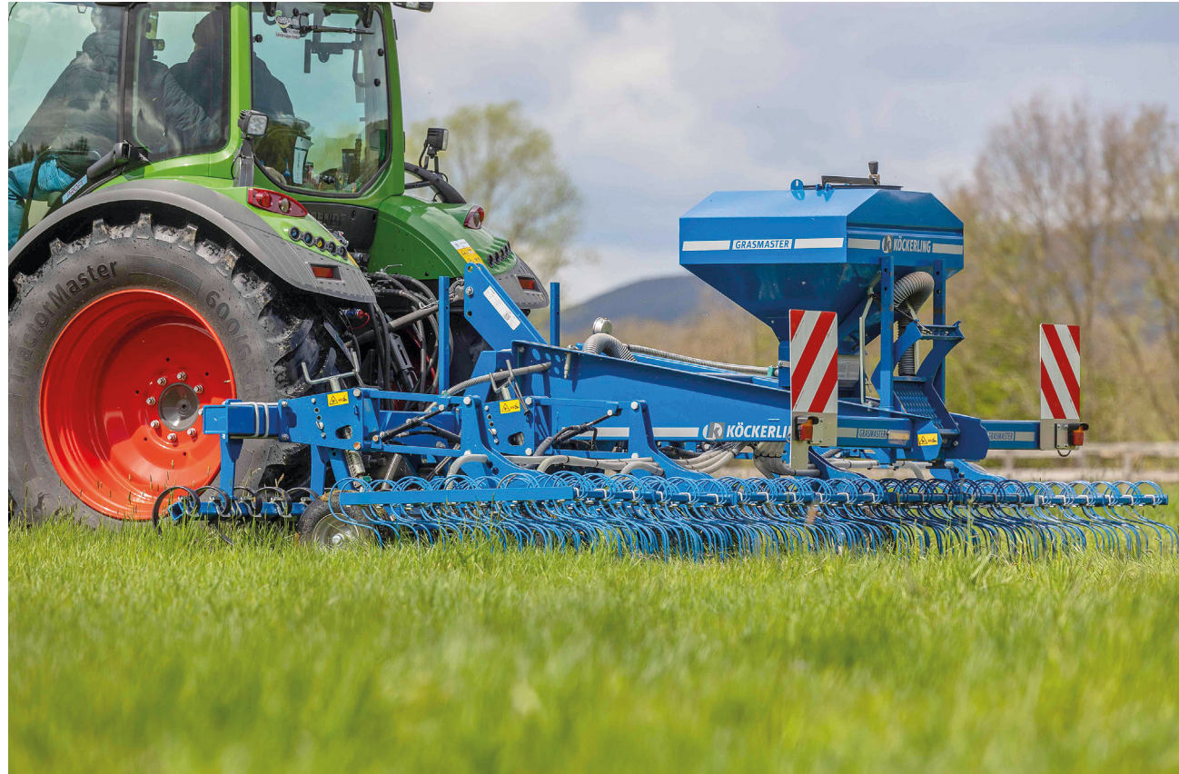
Luční brány Köckerling Grasmaster nekompromisně vyvážejí starou trávu, srovnají pozemek po krtincích a rozryté plochy po lesní zvěři, eventuelně dosejí poškozené plochy. Mohou se použít i pro vláčení plevelů v jařních.
