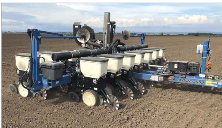
Přesný secí stroj Kinze 3500 8R Interplant při setí řepky. Změna rozteče řádků ze 75 cm na 37,5 a zpět je snadná a obsluhuje na poli zabere maximálně deset minut. Stroj je možné vybavit jak kapalným, tak i granulovaným přihnojením
