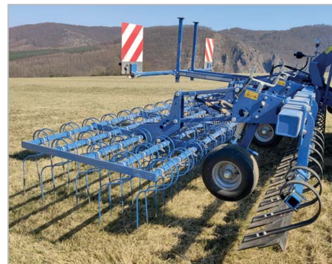
Jednoduchá, ale velmi účinná konstrukce bran
