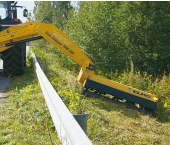
Jeřábové rameno mulčovače TPM 520 překoná svodidla a může bez problémů pracovat za nimi.
