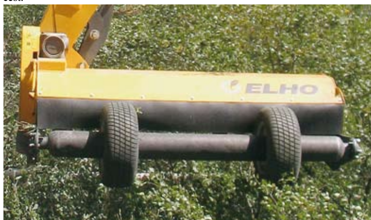
Opotřebitelné plazy z 16 mm silné oceli Hardox garantují dlouhou životnost.
