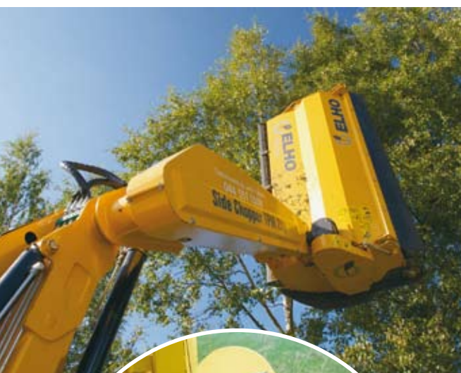
Jeřábové rameno mulčovače TPM 520 překoná svodidla a může bez problémů pracovat za nimi.
