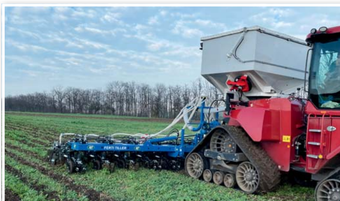
Foto 1 - Ferti Tiller - 900 12 řádků v agregaci s traktorem Quadrac 620 k při práci na pozemku s meziplodinou (podzim 2021)
