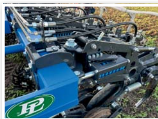
Foto 2 - Patentově chráněný systém horizontálního jistění pracovních jednotek stroje Ferti Tiller 900 od společnosti P & L
