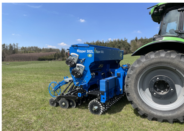
• Obr. č. 1. Nový koncept sečího stroje Ripper 302 s roztečí řádků 13,6 cm a dvoukomorovou výsevní skříní.
