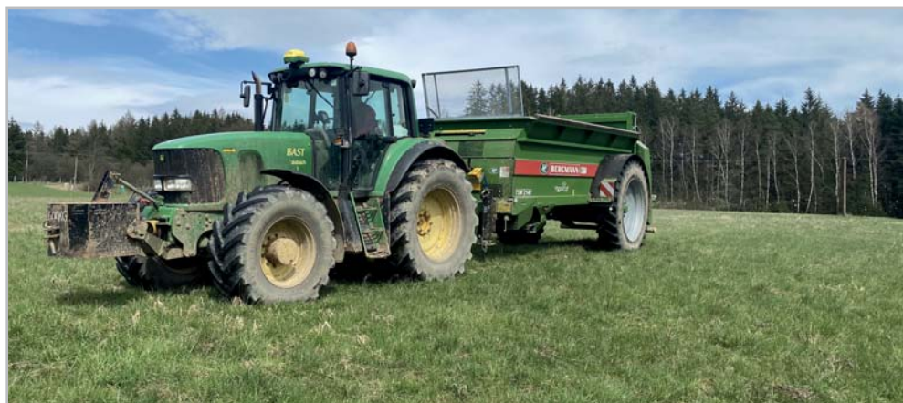
Pro agregaci s rozmetadlem je využíván traktor John Deere o výkonu 150 k
