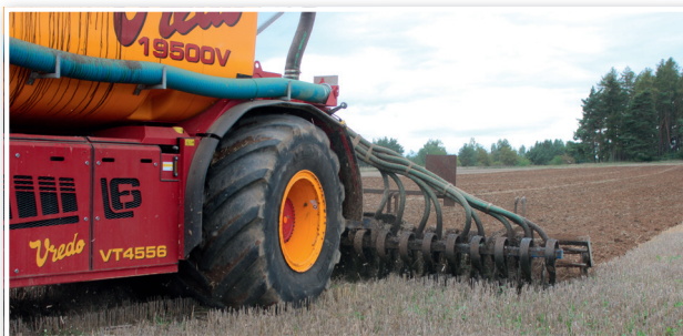
Samojízdný aplikátor Vredo firmy AGRO VajKub v režimu krabiho chodu při aplikaci do strniště talířovým aplikátorem Köckerling Rebell
