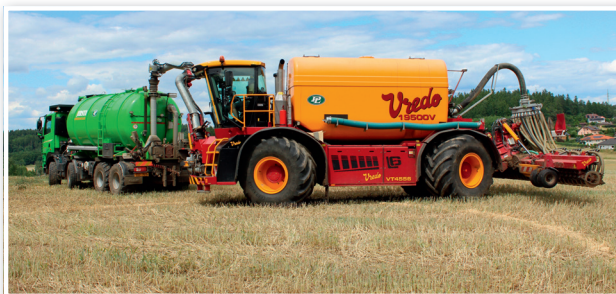
Aplikátor Vredo společnosti AGRO VajKub při plnění z cisterny na nosiči Tatra společnosti JIRSTA. Aplikátor je naplněn za necelé tři minuty
