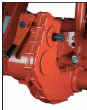
2 – stupňové řazení optimalizuje rychlost vtažování zvláště při velkých děláčích řezanky.
