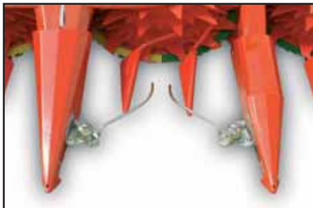
Mechanické řádkové navádění Snímá řady prostřednictvím snímačů. Pro usnadnění práce řidiče.
