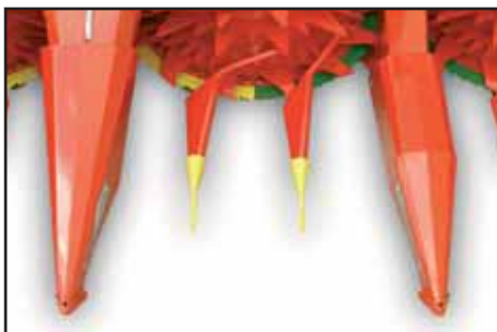
Nasaditelné hroty zvedačů stébel Při extrémních polehlých porostech zvedačů kukuřičná stébla.
