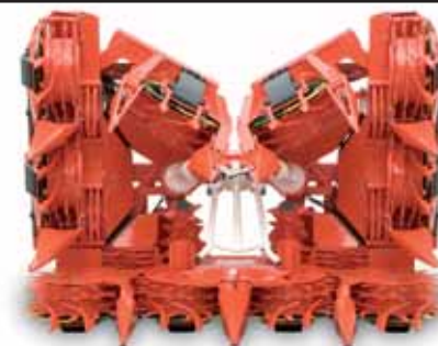
375 – transportní šířka 2,98 m, hydraulické dvojité sklápění pro ještě lepší výhled pro řidiče
