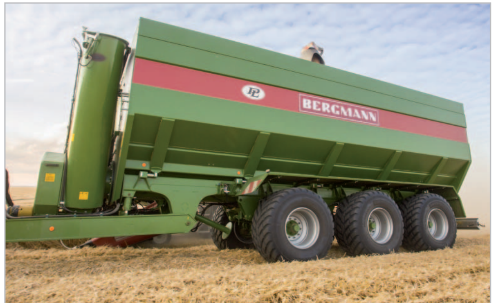
Třínápravový podvozek zaručuje i u tak velkého vozu malé utužení půdy
