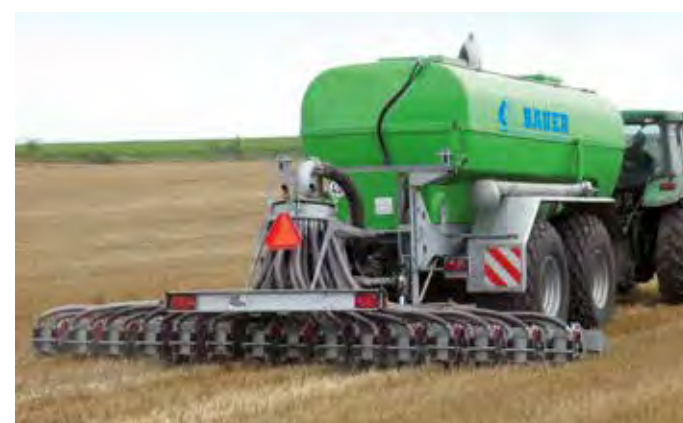
Trojdielné ONE-way drážkové kotouče umožňují přesné řezání a rozšiřují štěrbinu pro kejdu.
