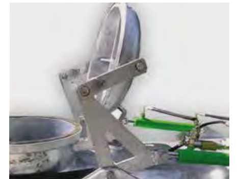
Dodatečná kupole o Ø 450 mm, hydraulická otevíratelná
