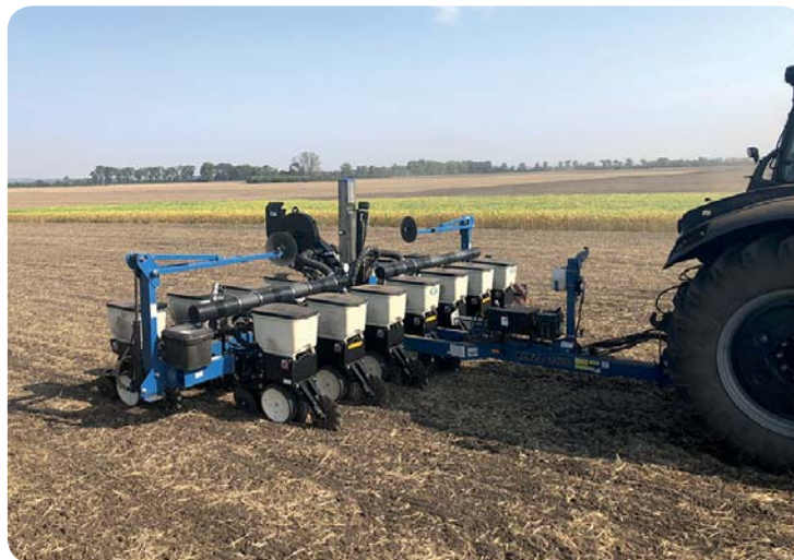
Secí stroj Kinze 3500 při setí řepky. Stroj umožňuje snadnou změnu rozteče řádků ze 75 cm pro kukuřici na rozteč 37 cm pro řepku, sóju a další plodiny
