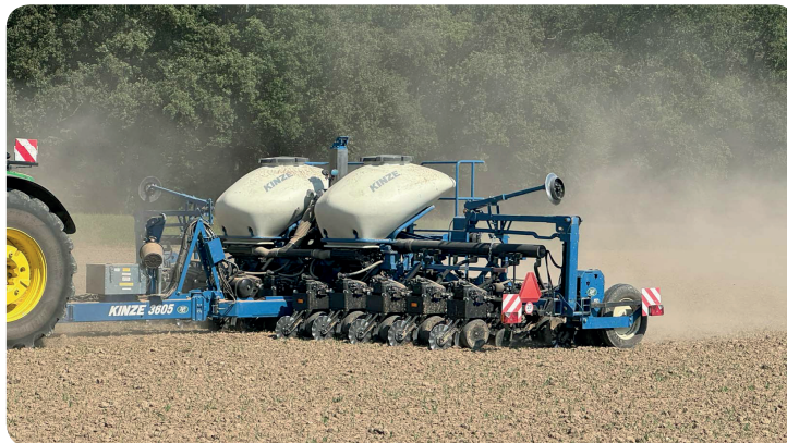
Obr. 1 – Přesný secí stroj Kinze 3605 12 R Interplant při setí řepky v Unčovicích v roce 2024. Secí stroj je vybaven novým výsevním ústrojím True Speed pro vysokou přesnost distribuce semen
