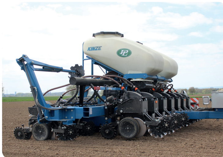
Přesný secí stroj Kinze 3505 ASD 8R Interplant s dvěma centrálními zásobníky
