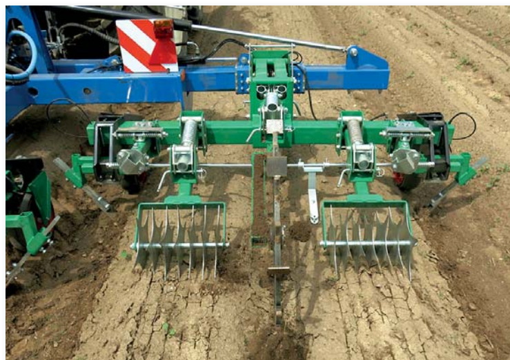
► Hydraulicky posouváná krajní sekce rozrušující pomocí hvězdicových válců krustu na povrchu hrůbků
