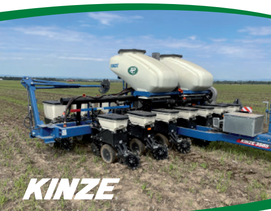
Přesný secí stroj Kinze 3505 8R Interplant při setí řepky (11. 8. 2023) na rozteč řádků 37,5 cm, výsevek 400 tis jedinců/ha
