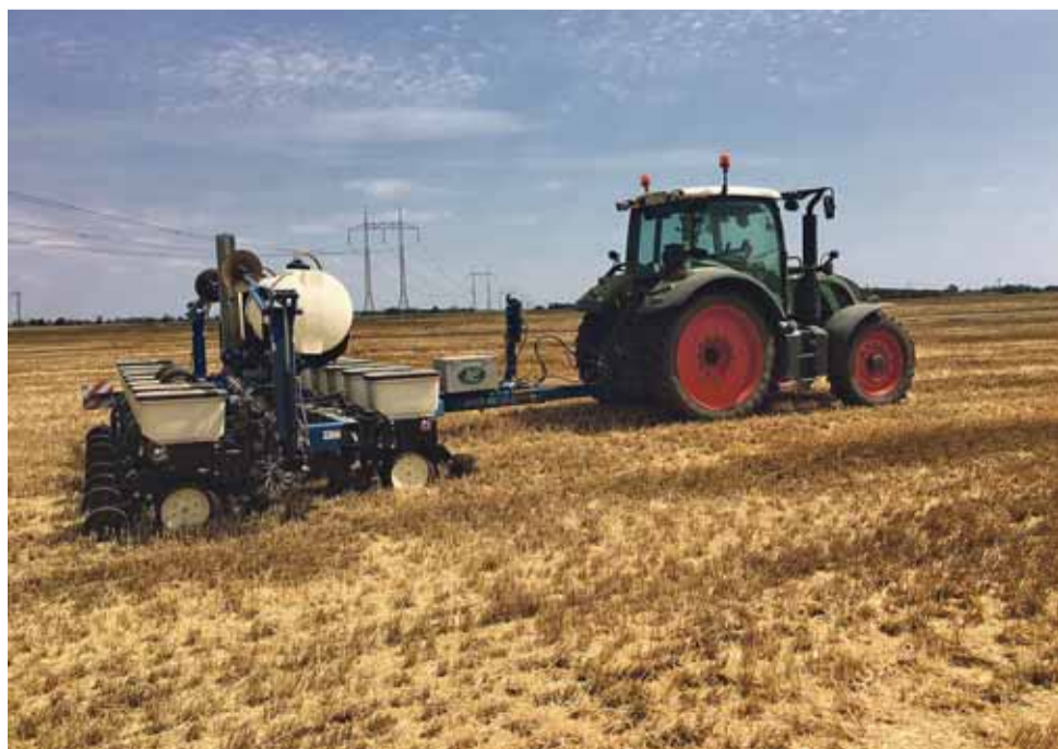
Obr. č.3. Secí stroj Kinze 3500 8 R Interplant má celkem 15 botek, z toho 8 v zadní řadě a 7 v přední. Technologie je vhodná nejen pro kukuřici, ale především pro řepku, sóju a směsné kultury.
