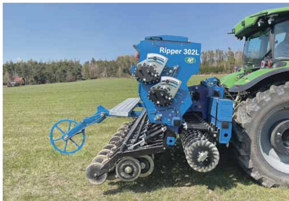
Obr. č.1. Nový koncept secího stroje Ripper 300 s roztečí řádků 13,6 cm a dvoukomorovou výsevní skříní.
