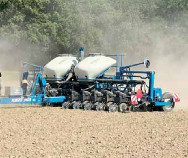
Přesný secí stroj Kinze 3605 12 R Interplant při setí řepky (37,5 cm) v Unčovicích v roce 2024. Secí stroj je vybaven novým výsevním ústrojím True Speed pro vysokou přesnost distribuce semen. Foto archiv firmy
