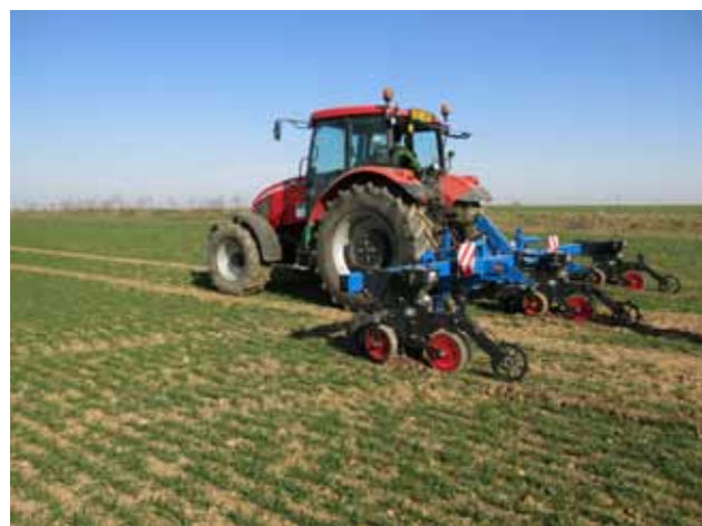
Obr. č.2. Terrier ve třířádkovém provedení při aplikaci v ozimé pšenici.
