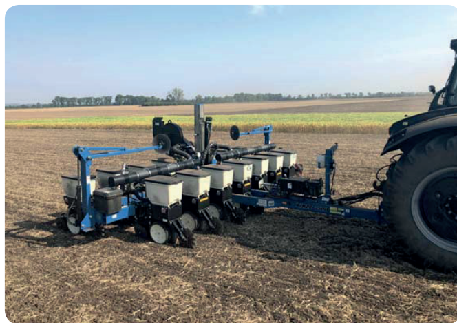
Obr. 1 – Secí stroj KINZE 3500 8R Interplant seje na šířku řádku 75 cm (8 řádků) nebo na 37,5 cm (15 řádků). Velkou předností tohoto stroje je skutečnost, že nejen umí sít širokou škálu plodin, ale změnu rozteče řádků provede samotná obsluha přímo na poli během několika minut
